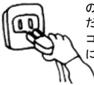
電源コードを抜くときは、必ず先端の電源プラグを持って引き抜いてください。
